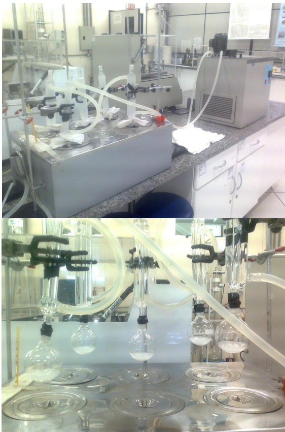
Figura 9 – Sistema utilizado para a síntese do composto \text{TiO}_2\text{-La} 0,05%–CMCD.
