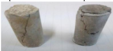
Figura 55 – Amostras após rompimento no ensaio à compressão.
