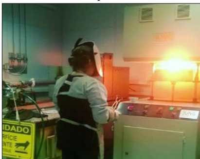
Figura 11 – Retirada das amostras clinquerizadas do forno elevador.
