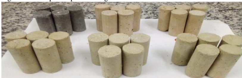
Figura 14 – Corpos de prova de argamassa.
