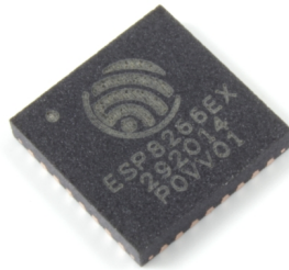
Figura 5 – ESP8266EX: núcleo dos módulos ESP.
