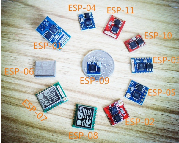
Figura 7 – Comparativo de alguns módulos ESP com uma moeda. Extraído de: (CURVELLO, 2015)
