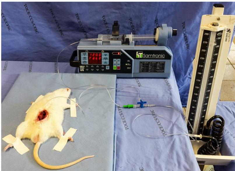
**Figura 9.** Sistema em "Y" ligado a bomba de infusão contínua e ao manômetro de mercúrio para medida da pressão de ruptura.
