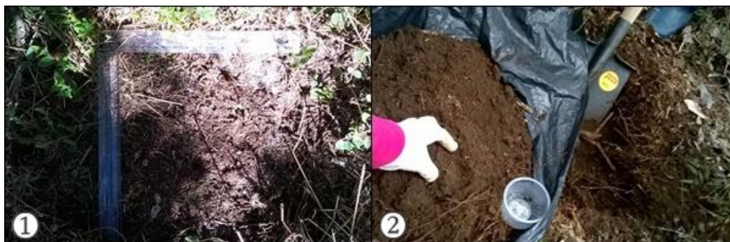
Figura 4 — Metodologia TSBF, com a escavação de monólitos, sendo 1) Coleta da Serrapilheira e demarcação no solo e 2) Escavação do monólito e coleta do solo.
