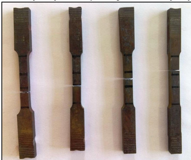
Figura 3.9 – Corpos de prova de tração, de algumas amostras, após ruptura.
