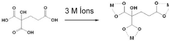
Figura 9 - Mecanismo de complexação de ácido cítrico com metais
