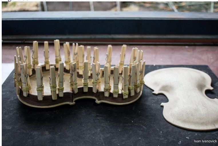
Figura 53 - Rabeca sendo feita no modo aro. Foto Ivan Ivanovick.
