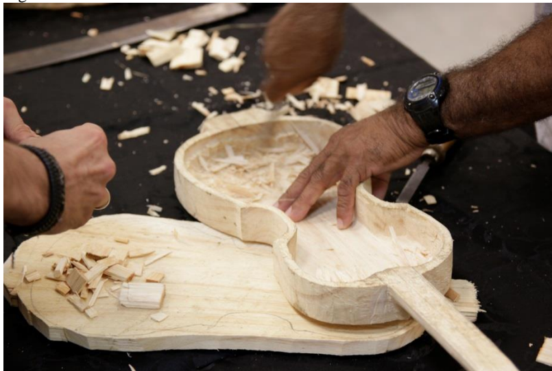
Figura 52 - Rabeca sendo feita no modo cocho ou cavocado.
