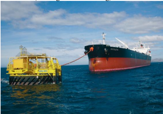
Figura 41 - Monoboia (ou Single Pont Mooring) conectada a navio.
