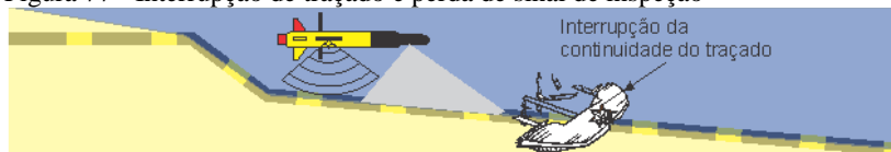
Figura 77 - Interrupção de traçado e perda de sinal de inspeção
