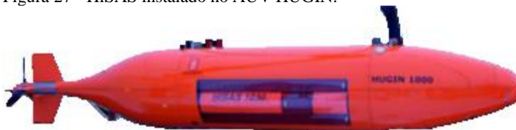
Figura 27 - HiSAS instalado no AUV HUGIN.
