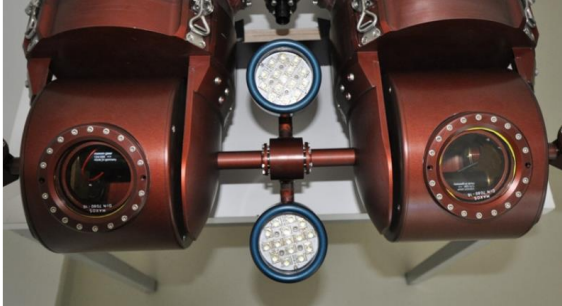
Figura 16 - Câmera estereoscópica com iluminação LED do AUV AVALON.
