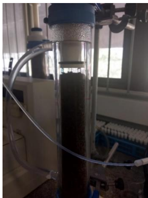
Figura 33. Coluna de leito fixo empacotada com a alga Pelvetia canaliculata bruta.
