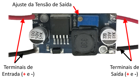
Figura 22 – Conversor DC/DC abaixador de tensão ( buck ) ajustável.
