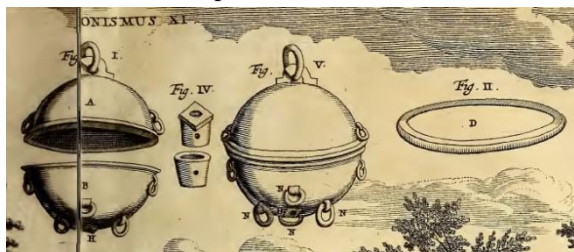
Figura 17 – Zoom in na figura 11. Detalhes, e um exemplo, da esfera oca utilizada no experimento “Hemisférios de Magdeburgo”. Fonte: GUERICKE (1672, p.104-105).
