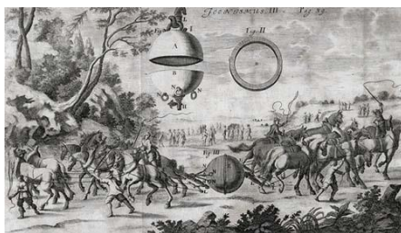
Figura 16 – Ilustração do experimento “Hemisférios de Magdeburgo”, de Kaspar Schott, presente no livro “ Mechanica hydraulico-pneumatica ” de 1657. Fonte: < http://www.imss.fi.it/vuoto/eesper4.html >.
