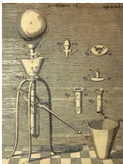
Figure 14 - Bomba de vácuo de Guericke. Projeto para Friedrich Wilhelm, 1663. Fonte: GUERICKE (1672, p. 76).
