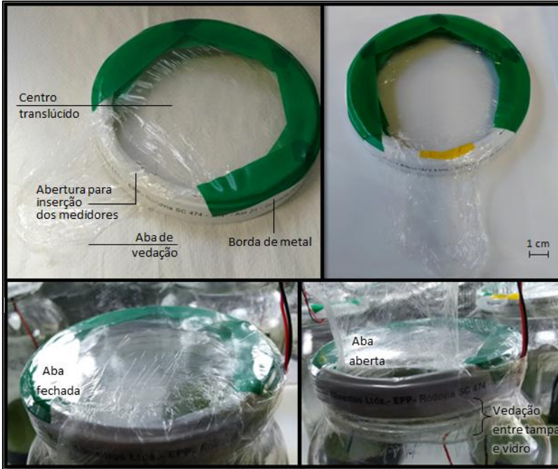
Figura 7 – Detalhamento da tampa do FBR.
