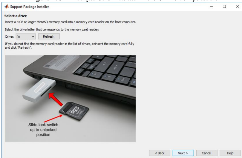
Figura 175 – Inserção de um cartão micro SD no computador.
