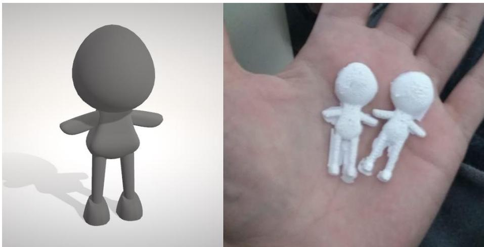
Na esquerda, modelagem 3D criada para a impressão do personagem Bilro Rendeiro. Na direita, impressão 3D de teste realizada no Senai – SC. Observe que o boneco de testes foi dividido em duas partes para facilitar a impressão. Além disso, seu tamanho foi reduzido para agilizar a confecção da peça.
