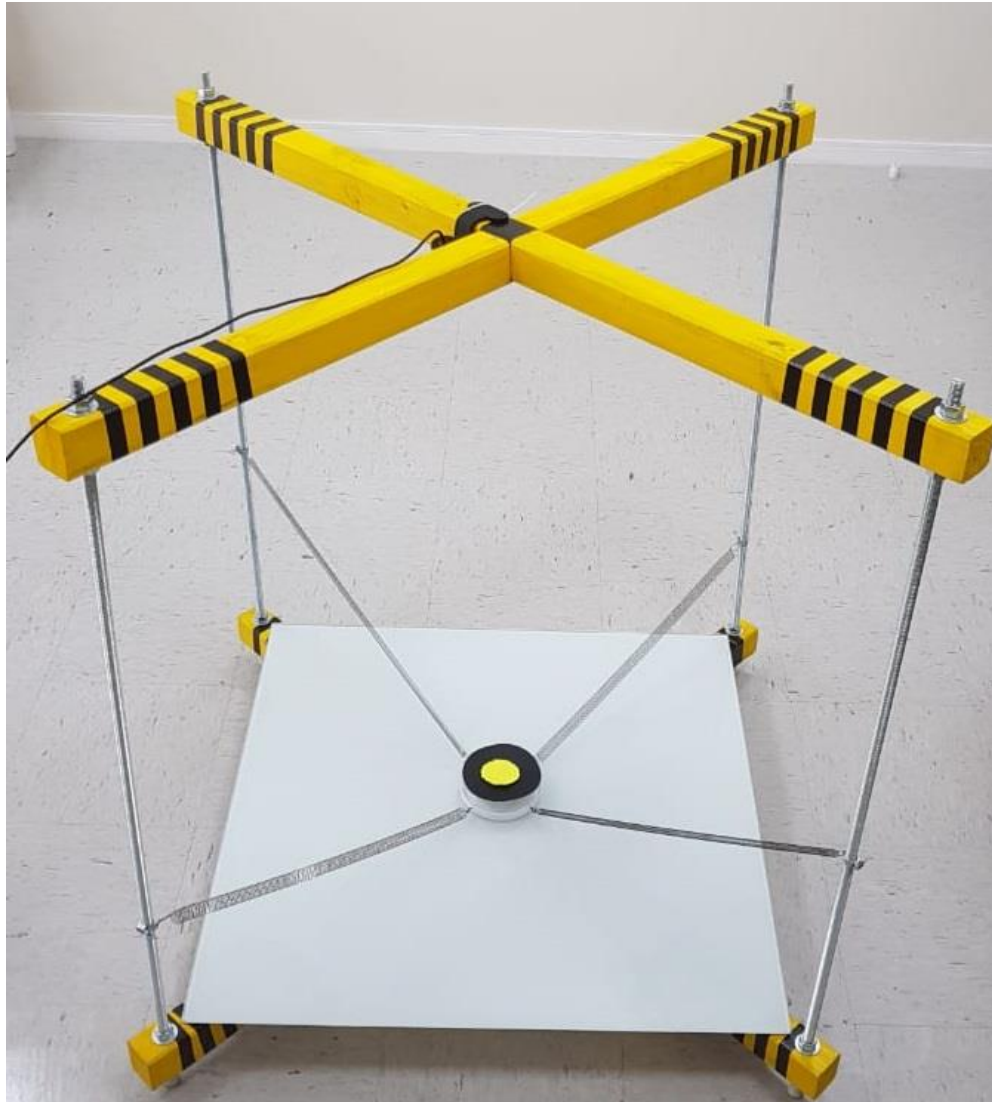
Figura 20 – Sistema massa mola com 2GDL
