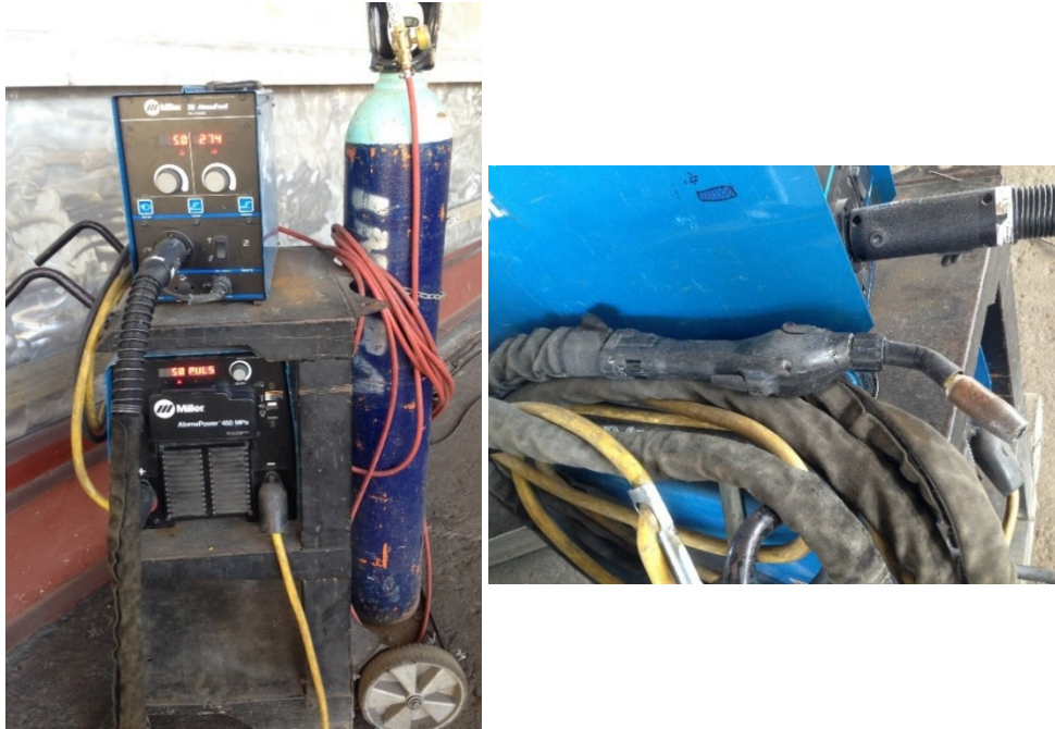
Figura 44 Equipamento para soldagem MIG em alumínio
