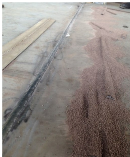
Figura 52 Resultado do cordão juntamente a sua escória
