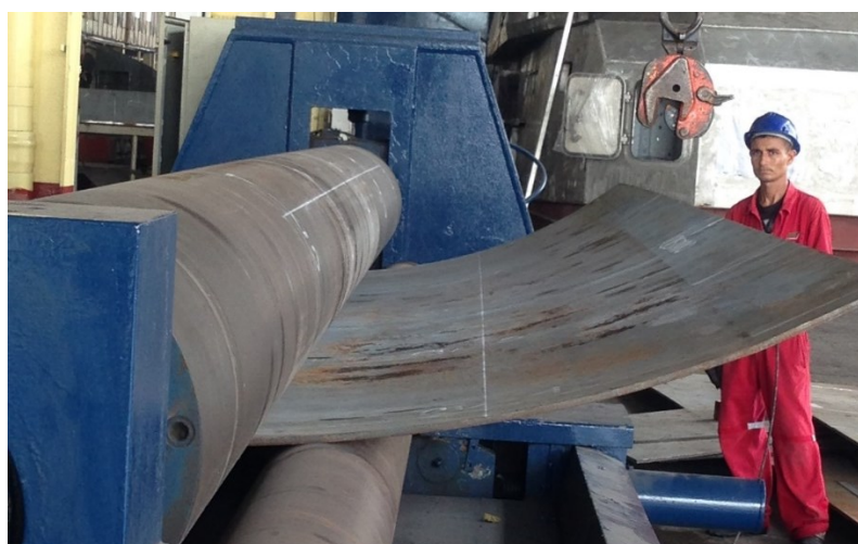
Figura 29 Conformação de uma chapa na calandra
