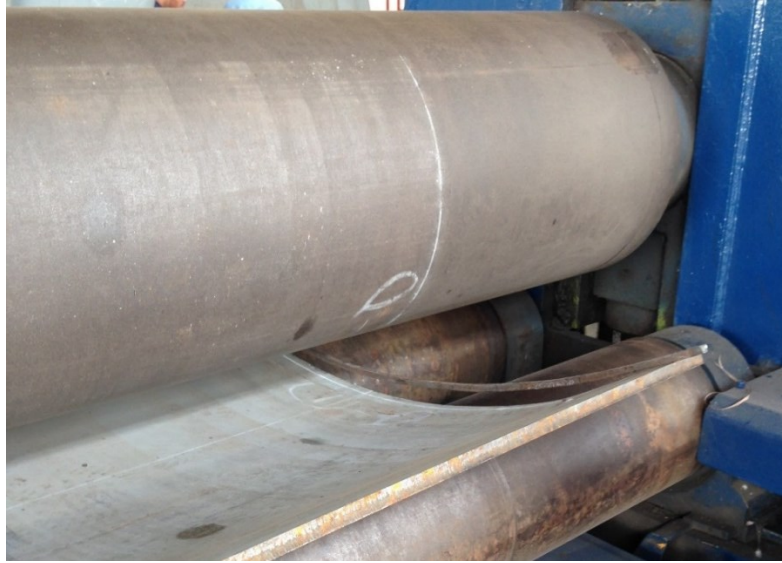
Figura 30 Verificação da conformação com um gabarito de aço
