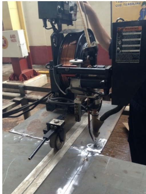
Figura 50 Emparelhamento entre o arame e o centro da união entre as chapas
