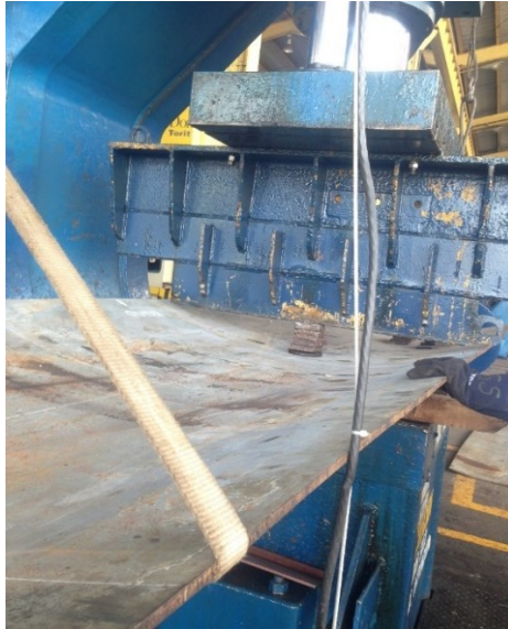
Figura 35 Pressão no eixo central da chapa
