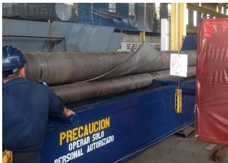
Figura 32 Conformação de uma chapa com eixo não centralizado
