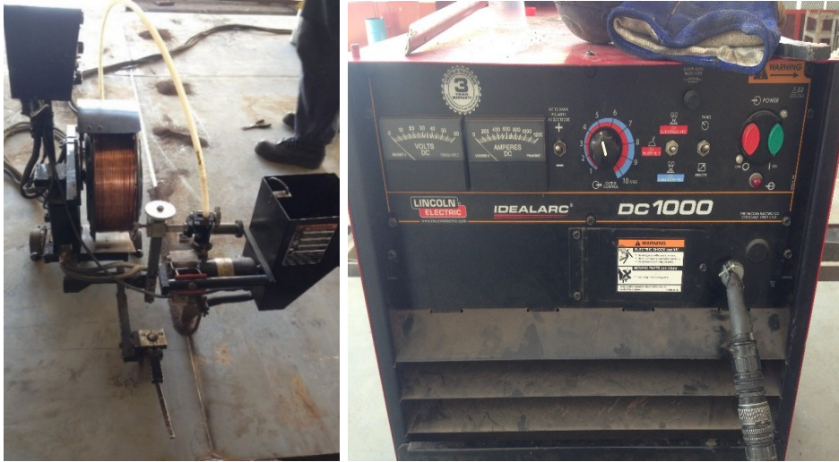
Figura 48 Equipamento utilizado para soldagem com arco submerso
