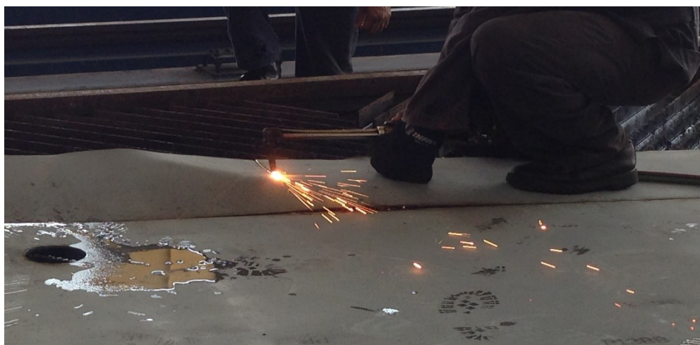
Figura 25 Procedimento de oxicorte
