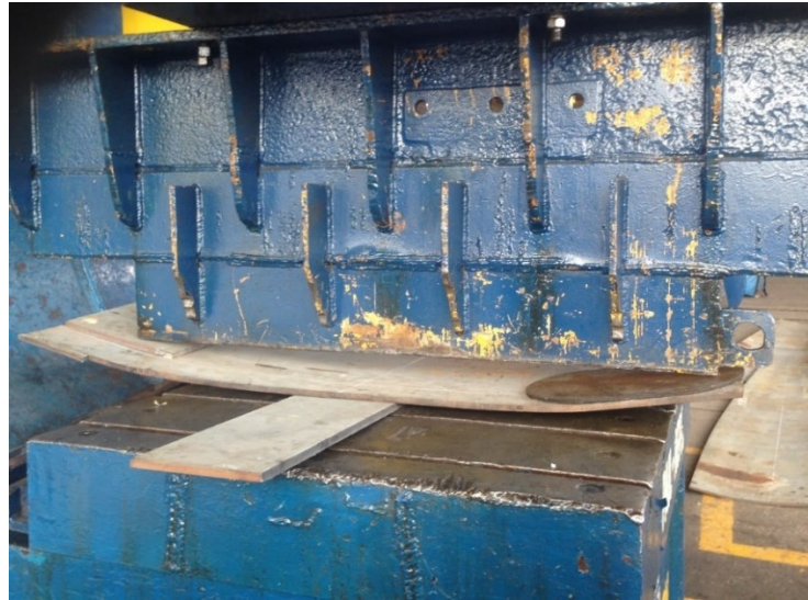
Figura 33 Aplanamento na prensa
