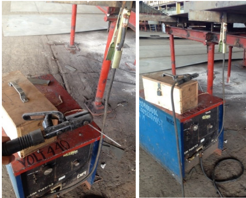
Figura 47 Equipamento para soldagem com eletrodo revestido
