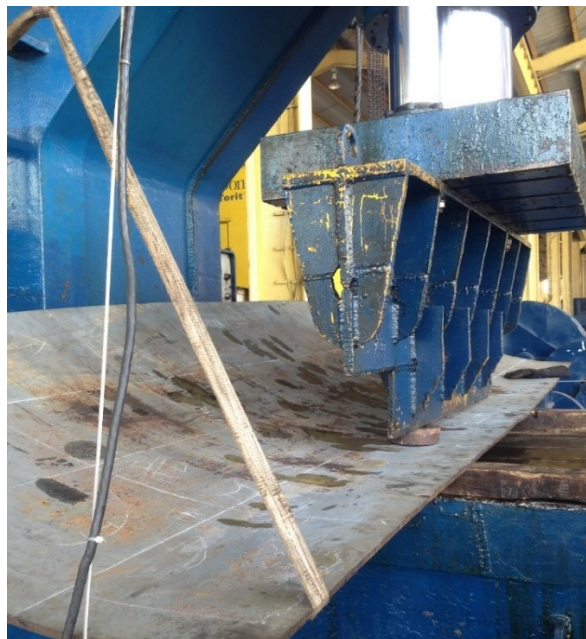
Figura 34 Conformação para uma chapa irregular
