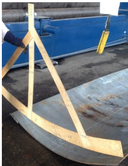
Figura 31 Verificação da conformação com um gabarito de madeira
