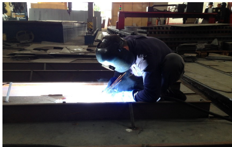
Figura 43 Realização da soldagem MAG com micro arame do tipo flux core
