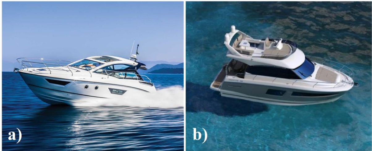
Figura 3 – Embarcações: a) com propulsão a motor navegando em modo de planeio; b) com propulsão a motor em modo deslocante.
