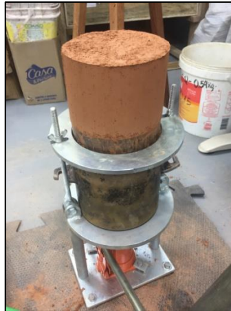
Figura 18 - Foto do solo compactado por ensaio compactação em cilindro grande.
