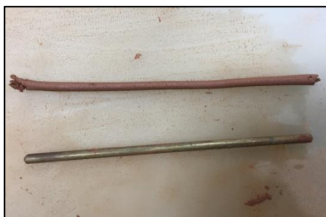
Figura 14 – Solo moldado no ensaio de limite de plasticidade.
