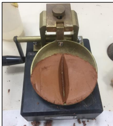
Figura 13 - Foto do solo inserido na concha do aparelho de Casagrande e pronto para ser ensaiado.
