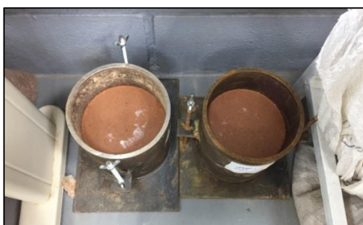
Figura 19 - Corpos de prova com solo aditivado, utilizados nos ensaios de ISC, durante o período de cura.
