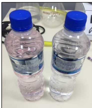
Figura 12 - Garrafas com líquido estabilizante em dosagens de 0,3% (a direita) e 0,45% (a esquerda) de Con-Aid® CBR-Plus diluído em água pura.
