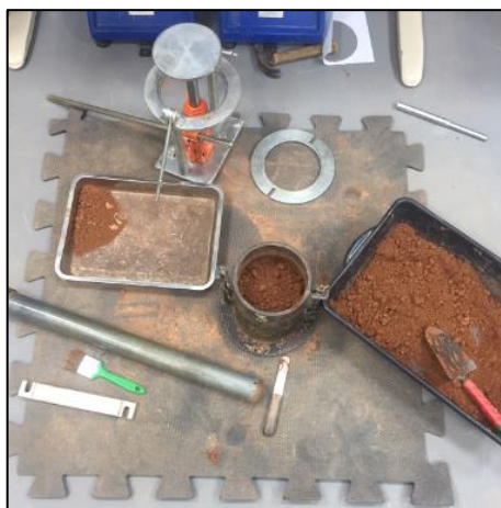
Figura 17 - Foto dos materiais utilizados para o ensaio de compactação com cilindro grande.
