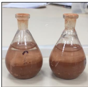
Figura 15 - Foto de dois picnômetros separados após o banho de água do ensaio de densidade real dos grãos.
