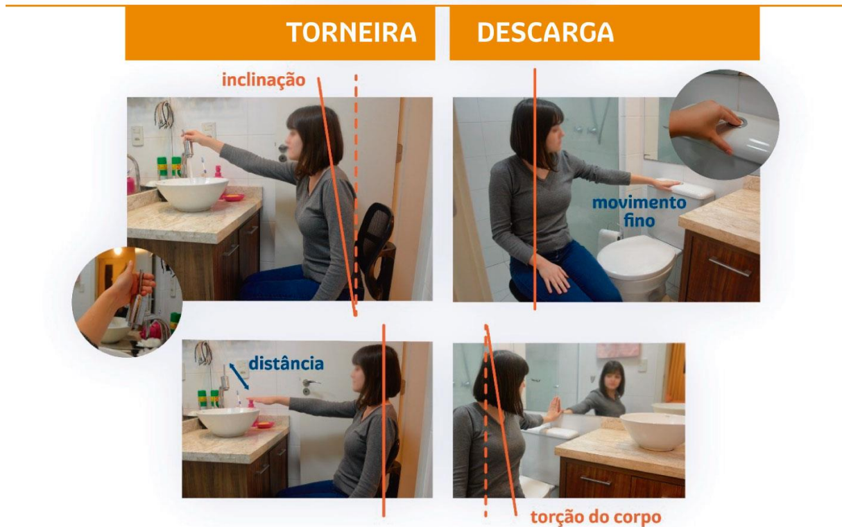
Figura 19 – Análise ergonômica do banheiro privado simulando o uso de cadeira de rodas
