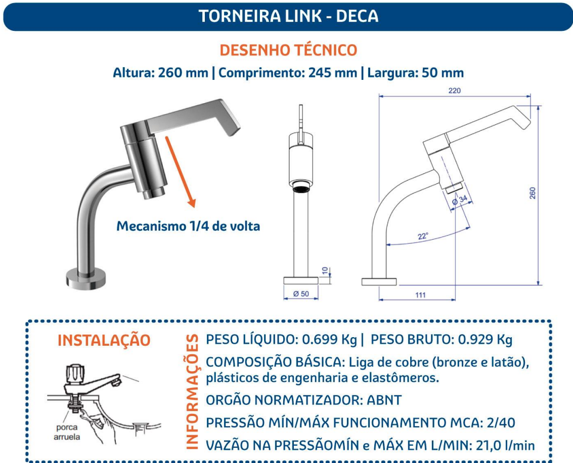
Figura 21 - Análise estrutural: torneira Link (Deca)
