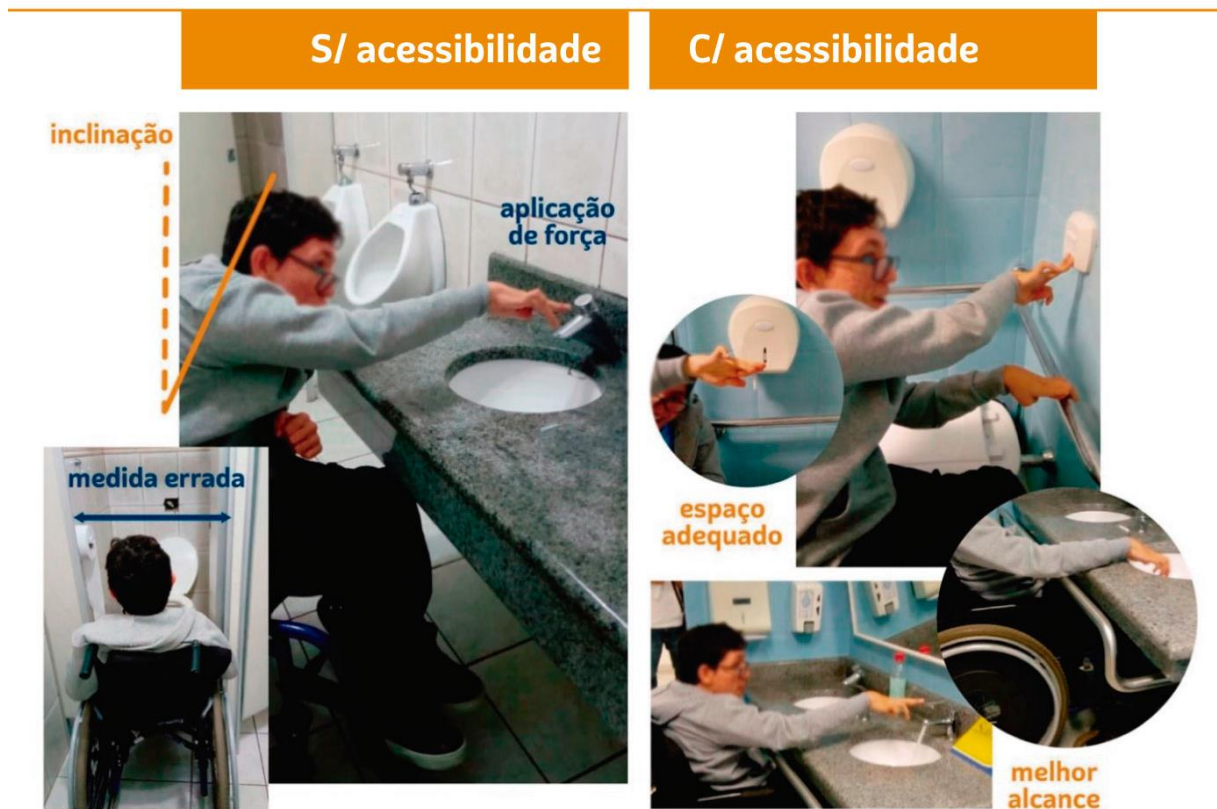
Figura 18 - Teste usabilidade do banheiro coletivo com um usuário de cadeira de rodas
