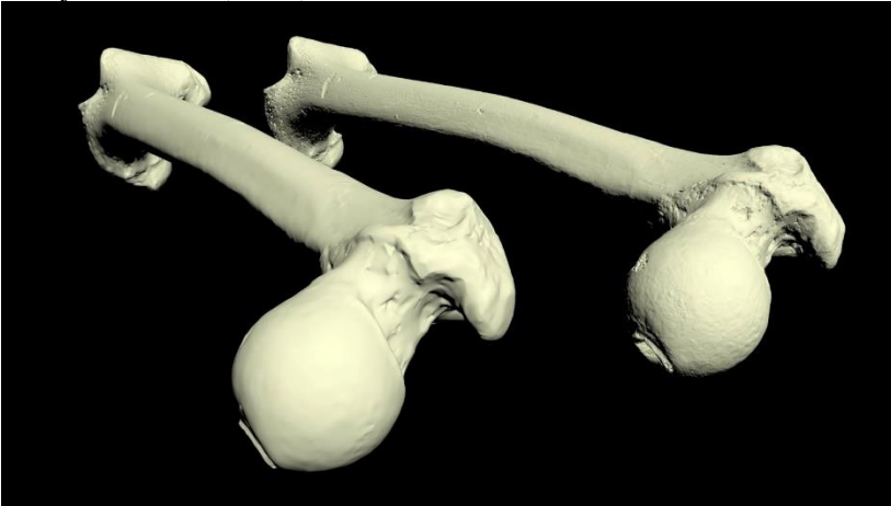
Figura 7: Digitalização de um fêmur utilizando a lente MV600 (esquerda) e com o conjunto MV150 (direita)
