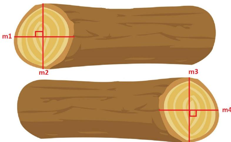
Figura 8: Medição de Raio das Bases da Tora
