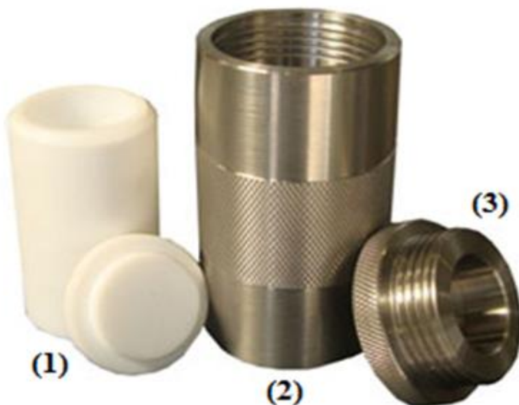
Figura 3 - Modelo autoclave utilizada no método hidrotérmico.
