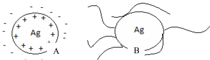
Figura 7: A) Estabilidade eletrostática B) Estabilidade estérica
