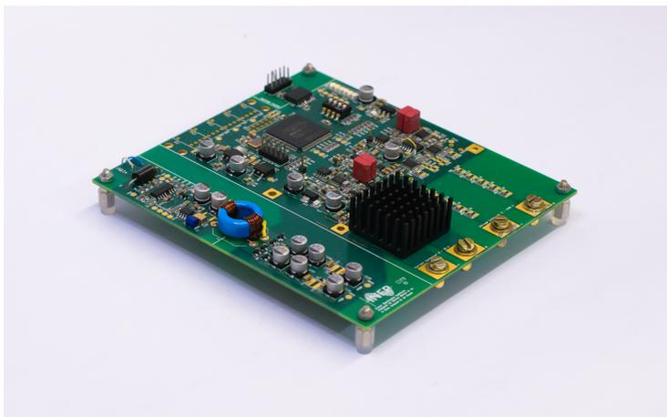
Figura 6.46 – Vista do protótipo da placa de aquisição.
