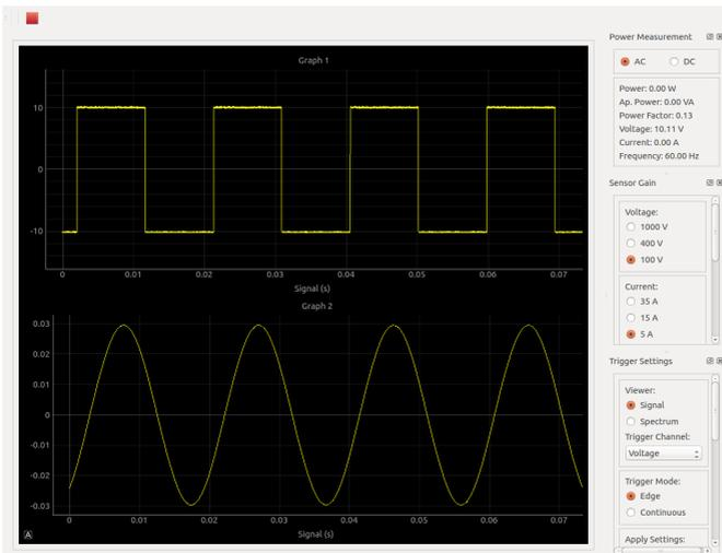
Figura 6.57 – Interface gráfica usada para validação da estimação de frequência de uma forma de onda quadrada. Sinal superior: forma de onda de entrada. Sinal inferior: forma de onda da saída do filtro banda passante.
