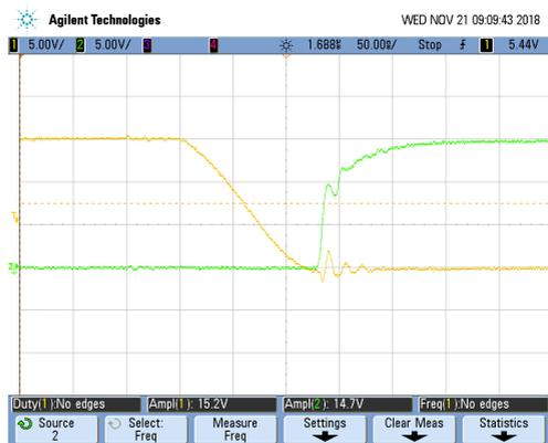
Figura 6.50 – Entrada em condução da chave  $S_2$  com tensão nula sobre os terminais. Sinal amarelo: tensão de entrada do tanque ressonante  $V_{hb}$ . Sinal verde: pulso de comando da chave inferior  $S_2$ .
