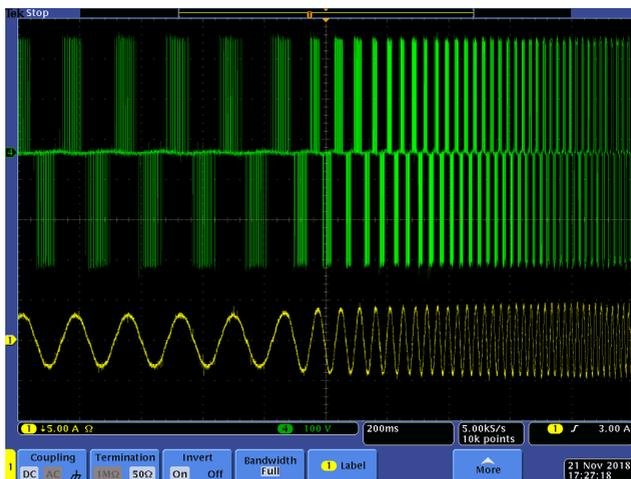
Figura 6.62 – Formas de onda do osciloscópio Tektronix em visualização no modo contínuo. Sinal verde: tensão de linha. Sinal amarelo: corrente de linha.
