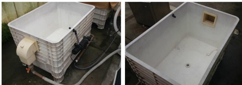
Figura 16. Imagens do tanque de 300L com luz UV acoplada utilizado para os ensaios de desinfecção vira
