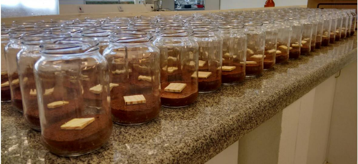
Figura 4 – Frascos de ensaio contendo placa suporte para o desenvolvimento dos fungos.
