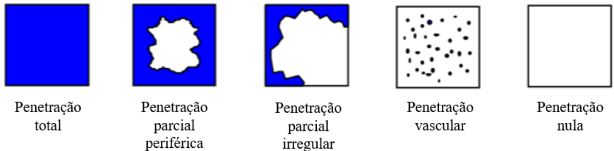
Figura 3 – Padrões utilizados para análise da penetração do produto preservante na peça de madeira.
