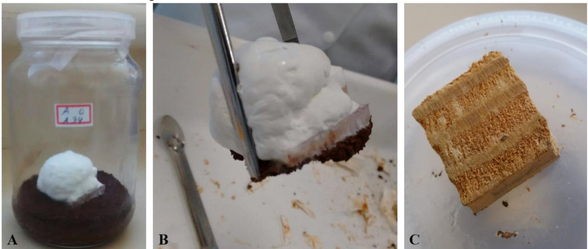
Figura 6 – Etapa final do ensaio de apodrecimento acelerado: micélio do fungo Trametes versicolor recobrendo tanto a placa suporte quanto o corpo de prova (A); Remoção do material retirado do corpo de prova para posterior limpeza (B); Corpo de prova após a retirada do micélio do fungo (C).
