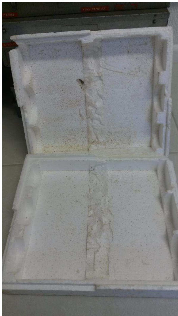
Figura 6 – Caixa de isopor apresentando pontos de degradação na parte interna, onde estavam acondicionadas as peças do acervo
