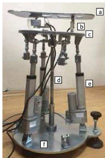
Figura 12 – Robô paralelo de reabilitação de tornozelo desenvolvido (a:plataforma de conexão de tornozelo; b:sensores de força; c:plataforma móvel; d:suporte central; e:atuadores lineares; f:plataforma de base).[8]
