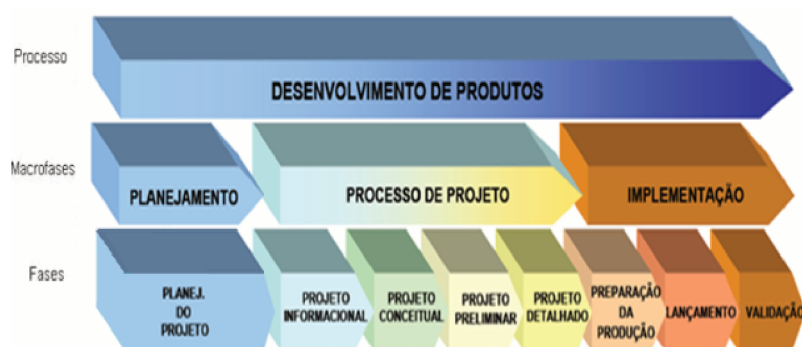
Figura 14 – Macrofases e fases de processo de desenvolvimento de produtos, adaptado de [10]
