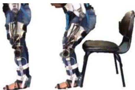
Figura 11 – Exoesqueleto robótico do joelho, controlado pela intenção de movimento baseado em sinais miográficos. [7]
