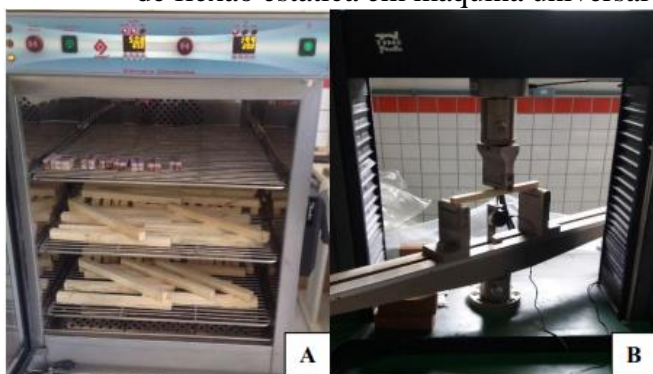
Figura 1 – Corpos de prova em condicionamento no interior da câmara climática (A); Ensaio de flexão estática em máquina universal de ensaios mecânicos (B).
