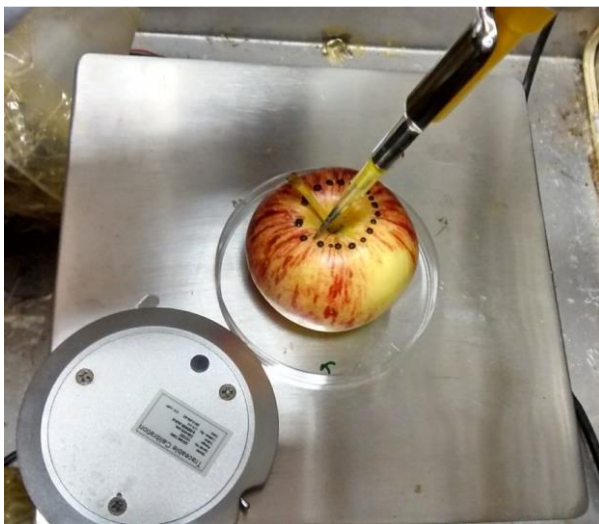
Figura 3. 8 Maçã com inóculo para ser submetida ao tratamento por radiação UV-C
