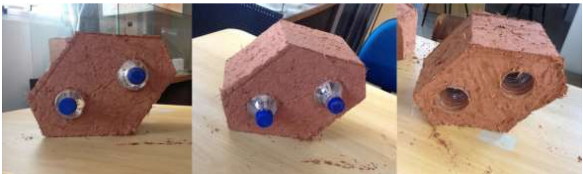
Tijolo de adobe, na proporção 3:1 com incorporação de fibras, após cinco dias da moldagem.
