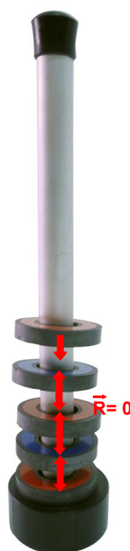
Figura 16 - Levitação dos ímãs – situação de repulsão forças opostas entre os anéis.
