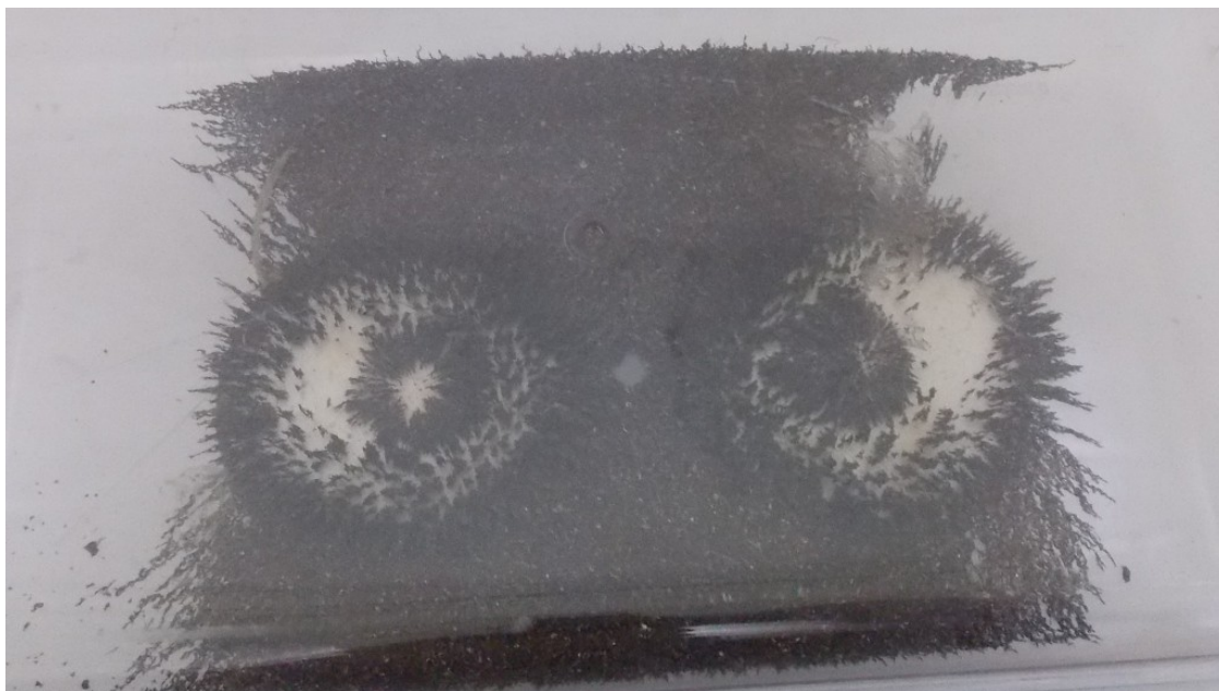
Figura 19 (d) - Linhas de campo com ímãs em situação de polos diferentes
