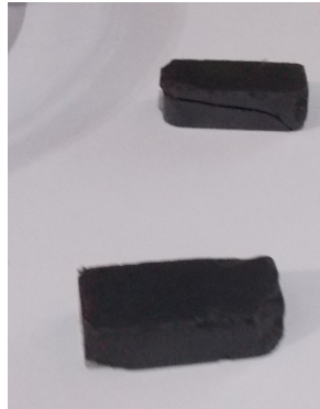
Figura 7. Ímãs retangulares, detalhe ímã na parte superior da figura possuía uma rachadura que o dividia ao meio.
