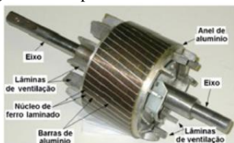
Figura 5.3 - Tipos de rotores de um motor elétrico.
