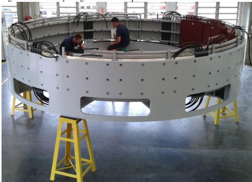
Figura 5.33 - Carcaça do gerador de ímãs permanentes sendo bobinada.
