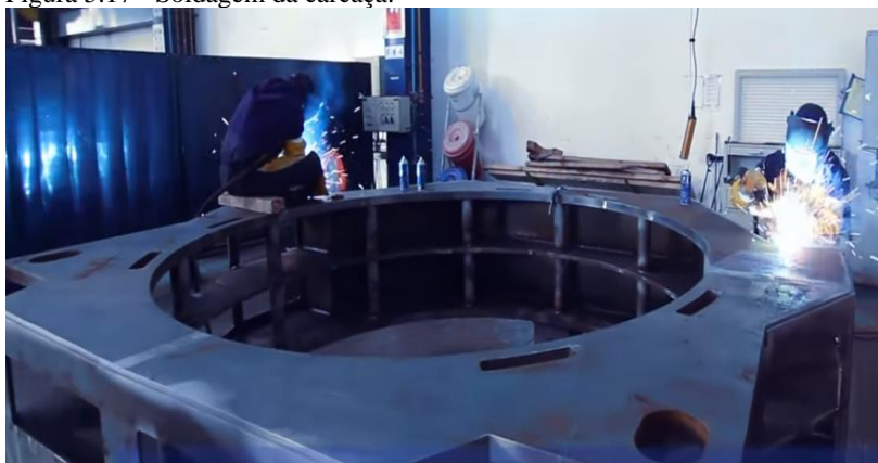
Figura 5.17 - Soldagem da carcaça.
