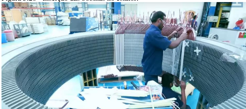
Figura 5.20 - Inserção das bobinas no estator.
