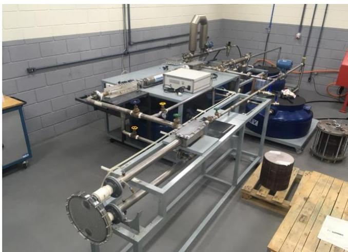
Figura 13 - Bancada de escoamento multifásico.
