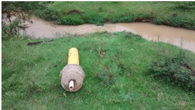
Observa-se na Figura 39, o primeiro episódio de cheia após a instalação dos piezômetros. É possível notar que o piezômetro foi removido de seu lugar de instalação devido à grande força de arraste da água do rio.
