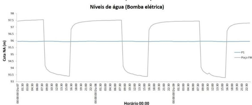
A bomba elétrica causou um maior rebaixamento no nível estático do poço de FM, como era esperado, pois a potência era maior que das bombas solares em série (Figura 54). A vazão da bomba elétrica era de aproximadamente 3,4 m<sup>3</sup>/h, que causou um rebaixamento de 4 m abaixo do nível estático do poço e de aproximadamente 2,5 m abaixo do nível de água do manancial.
