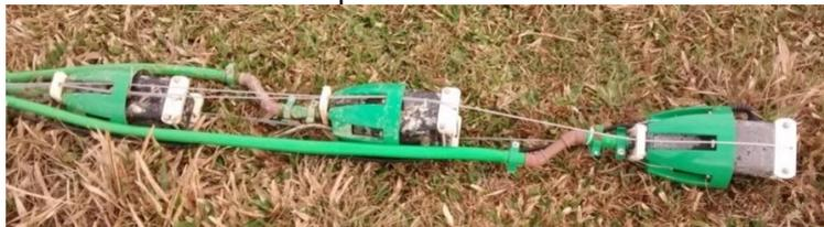
Não foram utilizadas baterias para armazenar a energia excedente gerada pelos painéis fotovoltaicos para que a bomba funcione durante a noite ou em períodos de baixa insolação. As bombas funcionavam durante todo o dia, bombeando o máximo de água para o reservatório superior e armazenando energia em forma de água (energia potencial). Quando o volume bombeado
