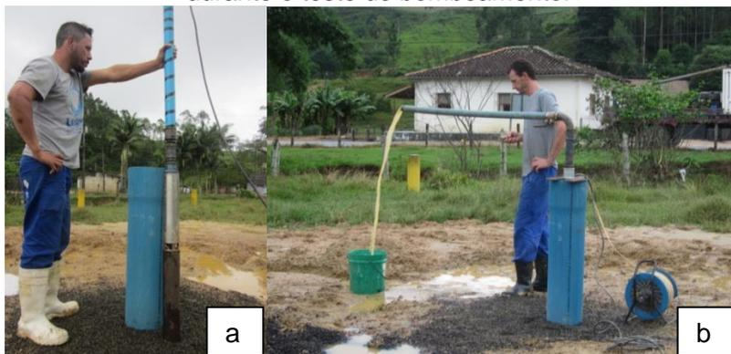
Ao final do teste obtiveram-se os dados da relação: nível de água no interior do poço pelo tempo, durante o rebaixamento e recuperação do nível de água. Com estes dados foi possível gerar um gráfico e determinar a vazão de exploração do poço.
