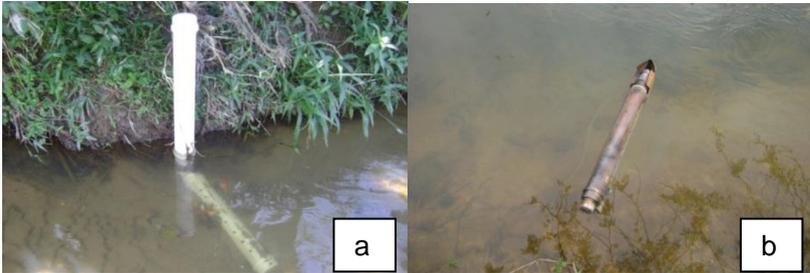
Na terceira configuração a sonda foi instalada na vertical em uma porção mais profunda do rio. A sonda ficava flutuando (por meio de uma boia) no interior de um tubo de 100 mm (Figura 35). Essa foi a melhor opção e mantida até o fim dos experimentos.
