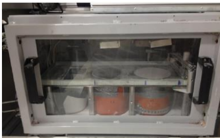
Figura 20 - Plataforma de alimentação (à direita) e a plataforma de construção (à esquerda) do equipamento SLS.
