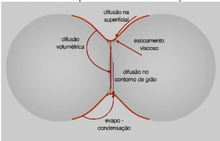
Figura 2 - Mecanismos de transporte de massa durante a sinterização.
