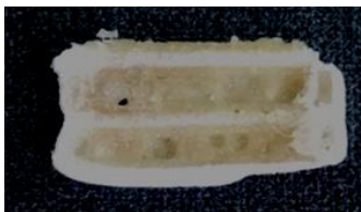
Figura 18 - Amostra de PEUAPM puro com potência de 40 W (30 mm x 5 mm x 4 mm).
