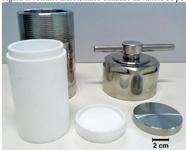
Figura 19. Reator hidrotérmico utilizado na síntese do pó de LSCF.
