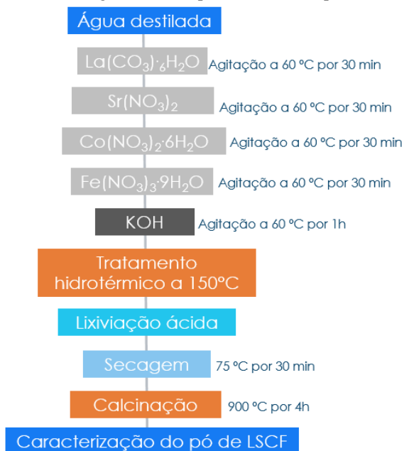
Figura 20. Fluxograma das etapas de síntese do pó de LSCF.
