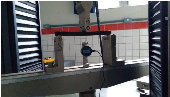
Figura 6 – Execução do teste de flexão estática em máquina universal de ensaios mecânicos.
