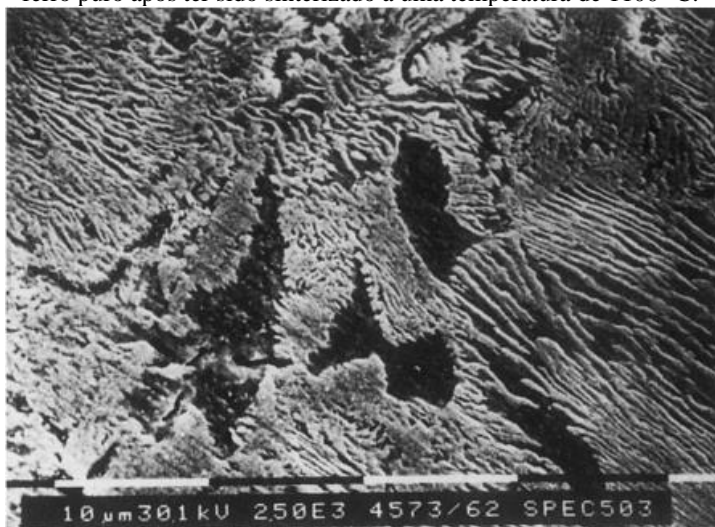
Figura 32: Micrografia obtida por MEV mostrando a microestrutura perlítica proveniente da decomposição de 5% de carbeta de silício em uma matriz de ferro puro após ter sido sinterizado a uma temperatura de 1100 °C.
