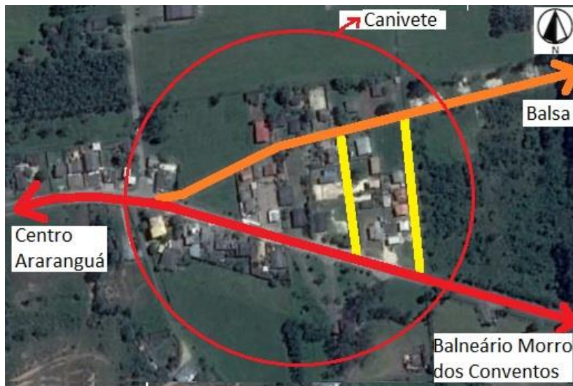
Figura 55 - Vista aérea a partir satélite da Bifurcação da localidade do Canivete. Na cor vermelha a via principal, na cor laranja a via secundária e na cor amarela via local.
