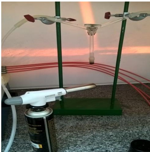
FIGURA 13 – Sistema vácuo/nitrogênio usado na etapa prévia à selagem das ampolas.
