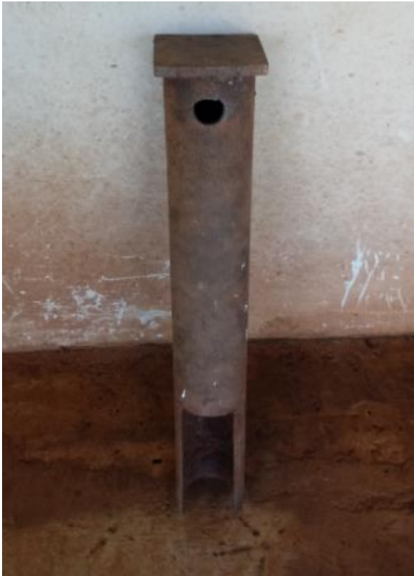
Figura 6 - Cano metálico utilizado para a retirada de solo com raízes
