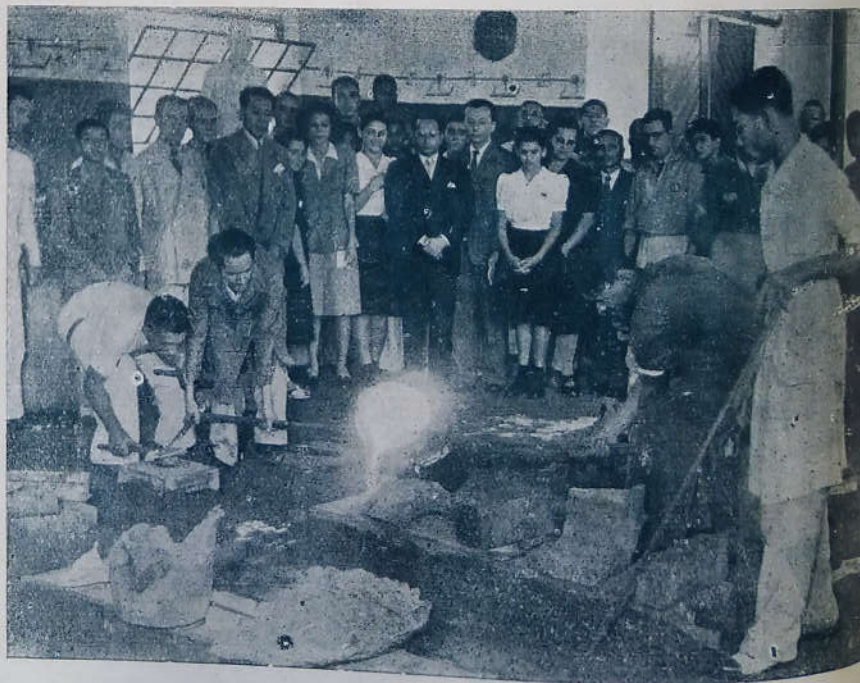
Atentos a uma demonstração experimental dos alunos da E.T.R., os excursionistas observam a fundição, em ferro, de peças destinadas às instalações daquele educandário.
