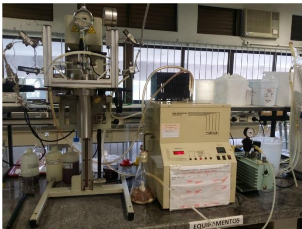
Figura 5: Aparato experimental (reator, banho termostaticado, bomba de vácuo e vacuômetro).
