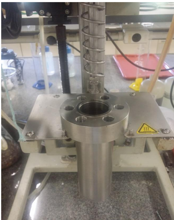
Figura 6: Sistema de agitação mecânica e serpentina interna.
