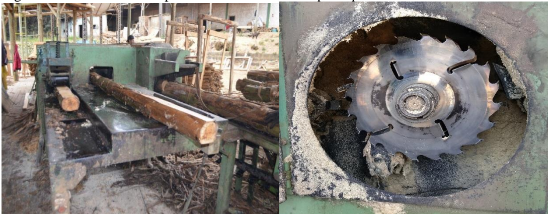
Figura 1 – Serra circular dupla utilizada no desdobro principal.
