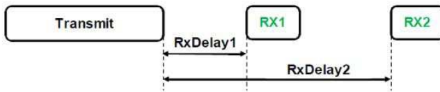
Figura 3 – Janelas de recebimento.
