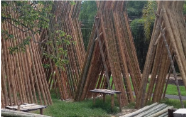
Figura 03: Secagem vertical do Bambu.
