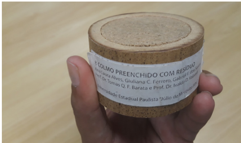
Figura 13: Amostra pertencente a Materioteca UFSC de colmo de bambu preenchido com resíduo. Fonte: Alves et. al. (2015). Foto: Librelotto (2019).
