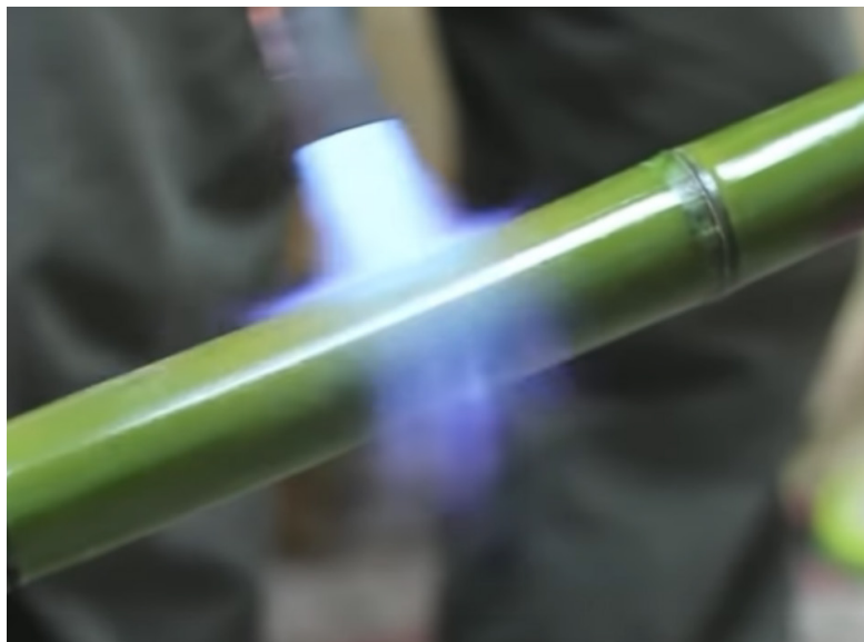
Figura 5: Processo de secagem utilizando maçarico. Fonte: Librelotto (2019).
