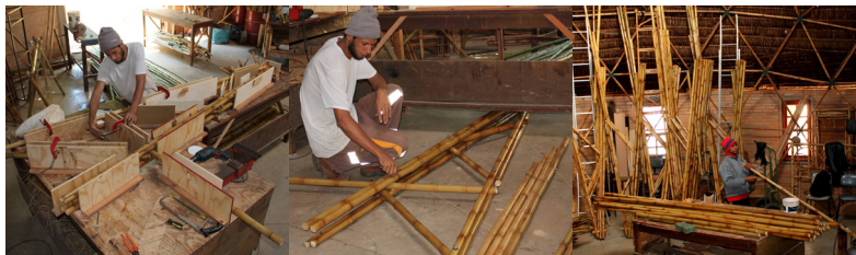
Figura 26: Pré-fabricação dos elementos estruturais. Fonte: Cerbambu Ravena, 2018.
