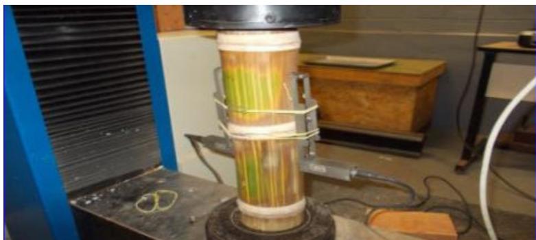
Figura 08: Ensaio de compressão paralela às fibras de bambu. Colmo de G. angustifolia . Fonte: Beraldo.
