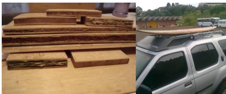
Figura 15: Placas compostas combinando bambu laminado por torneamento com outros materiais. Prancha de surf revestida com bambu laminado.
