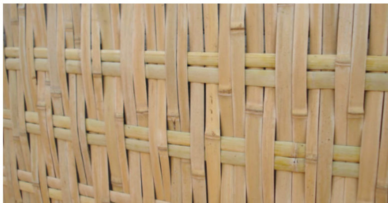
Figura 07: Processo manual de trançar tiras de bambu, formando painéis ou esteiras. Fonte: KASKA (2018).
