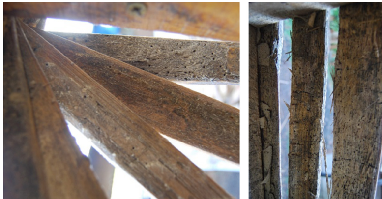
Figura 11: Ataque severo de D. minutus em produto de bambu modular ripado não tratado, de D. asper e B. vulgaris . Um ano após a instalação, vista da parte interna das ripas. Foto: Ostapiv.
