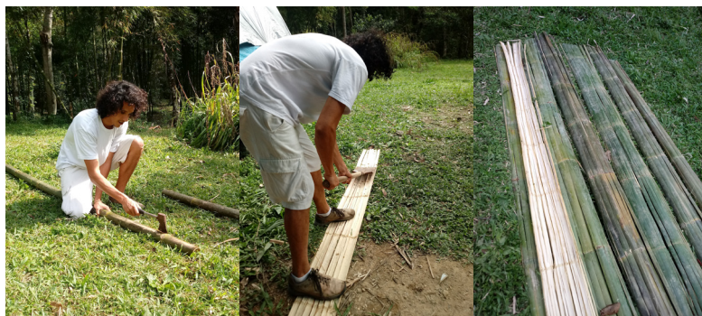
Figura 20: Processo de planificação do bambu. Foto: Vitor (2018)
