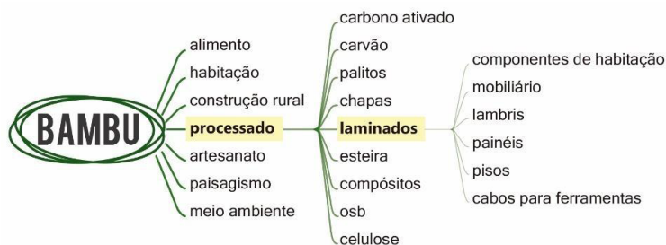
Figura 01: Organograma de possibilidades de utilização do bambu. Fonte: Adaptado de Pereira e Beraldo, 2016, p.155.
