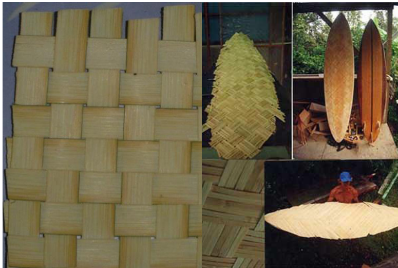
Figura 06: Placa de bambu trançado desenvolvida por Salamon (esquerda) e usos como revestimento de prancha de surfe por Gary Young, Hawaii (direita).
