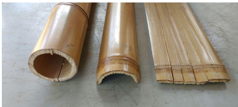
Figura 10: Bambu Aurea; colmo, meio colmo e planificado por dispositivo mecânico. Fonte: Salamon
