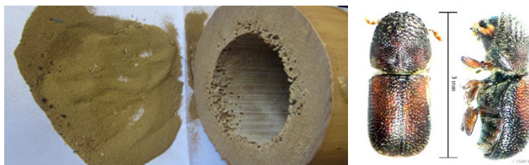
Figura 10: (A) Bambu não tratado atacado pelo caruncho (Fonte: Autor); (B) Dinoderus minutus , caruncho do bambu (Fonte: Liese, 1998).
