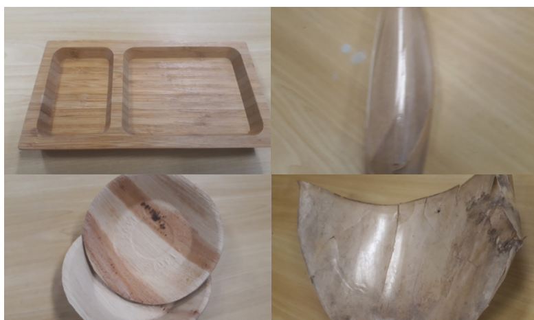
Figura 15: Objeto petisqueira feita em BLC (Bambu Laminado Colado), bainhas de bambus coletadas no sítio Çarakura que ao serem prensadas por conformação à quente podem originar pratos ecológicos. Amostras pertencentes à Materioteca UFSC. Doação: Jaramillo (2018) e sítio Çarakura. Fotos: Librelotto (2019).
