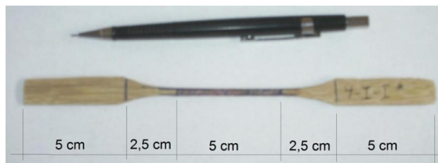
Figura 22: Corpo de prova de bambu utilizado nos ensaios de tração paralela às fibras. Foto: Carbonari.
