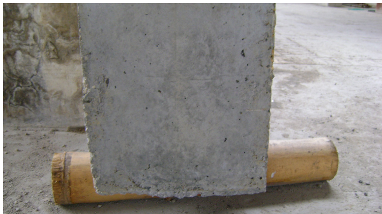
Figura 09: Carregamento aplicado na direção perpendicular às fibras do G. angustifolia . Fonte: Beraldo
