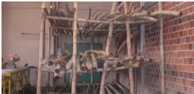
Figura 19: Estocagem dos colmos de bambu no laboratório de estruturas da UEL. Foto: Carbonari.
