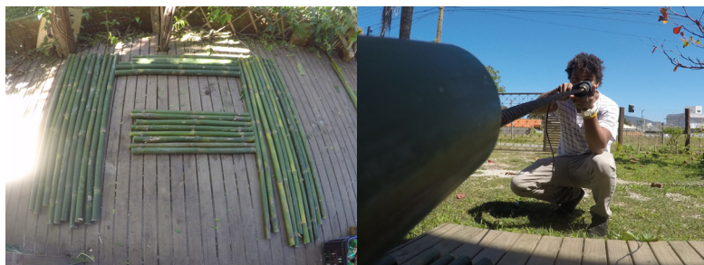
Figura 22: Preparação de bambusa tuldoides para tratamento. Foto: Vitor (2018)
