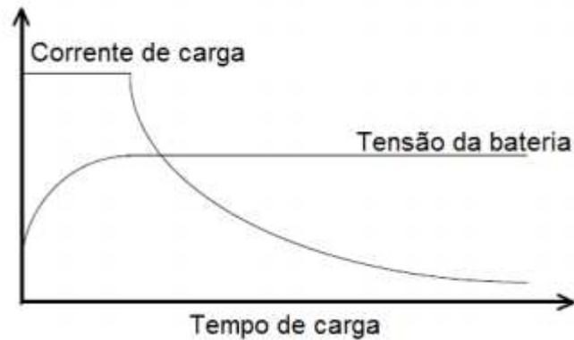
Figura 21 - Processo de carga da bateria.
