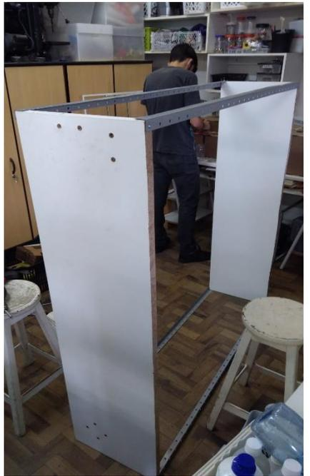
Para montar a estante utilizou-se quatro pedaços de uma mesa de MDF, quatro perfis laterais para rack e rodas para facilitar a mobilidade. Foi necessário a utilização de uma furadeira e uma parafusadeira para realizar o trabalho.
