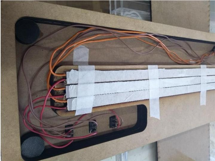
Depois de cortado foi feita a instalação de réguas de led para a iluminação das placas.
