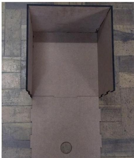
Depois do corte na máquina foi feito o processo de montagem das caixas, sem o uso de cola.
