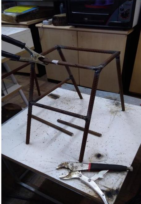
Assim como a estante de ferro, a estrutura do banco foi soldada utilizando uma solda comum com eletrodos revestidos.
